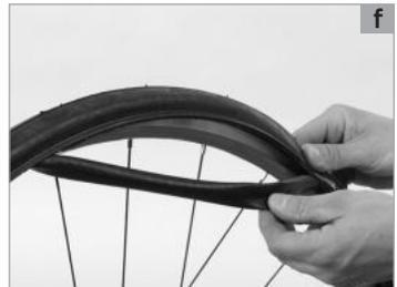
Bei Felgen mit doppeltem Boden, sogenannten Hohlkammerfelgen, muss es den ganzen Boden überspannen, darf aber nicht so breit sein, dass es an den Flanken hochsteht. Solche Felgen sollten Sie nur mit Bändern aus Textilgewebe oder festem Kunststoff kombinieren. Wenn Sie sich nicht absolut sicher sind oder Fragen haben, wenden Sie sich an Ihren SCOTT-Fachhändler.
