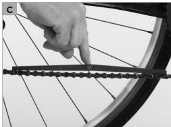
Diese Bauteile auszutauschen ist im Vergleich zum Kettenwechsel teuer. Überprüfen Sie deshalb regelmäßig den Zustand der Kette.
