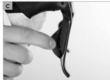
Ein Schaltvorgang beginnt, abhängig vom verbauten Schaltsystem, mit dem Betätigen einer Brems-Schalthebel-Einheit **(c)** oder eines Schalthebels **(d)** bei geraden Lenkern (Flatbars). Während des gesamten Schaltvorgangs muss pedaliert werden. Die Pedalkraft sollte aber spürbar reduziert werden.
